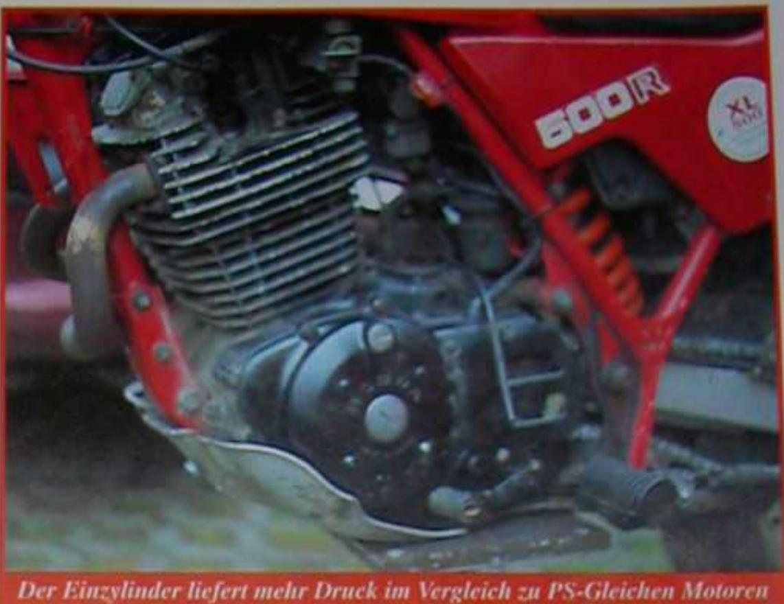
Der Einzylinder liefert mehr Druck im Vergleich zu PS-Gleichen Motoren
